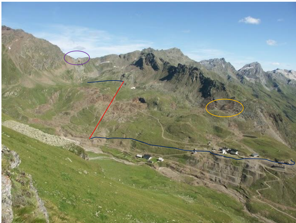
Abb.7.3: Überblick über das Schneeberger Revier. In dunkelblau sind die Flachstrecken markiert. In rot ist der 14- Nothelfer- Wassertonnenaufzug gekennzeichnet und in Gelb die Position des Schneekragens. Die Schneebergsscharte, über welche das Erz geschafft werden musste, ist lila markiert. Der vermessene Staudamm ist auf diesem Foto nicht einzusehen. Er befindet sich weiter links, sozusagen als Verlängerung der oberen Flachstrecke, ein Stück über den Bildrand hinaus (Widmann H, 2007).
