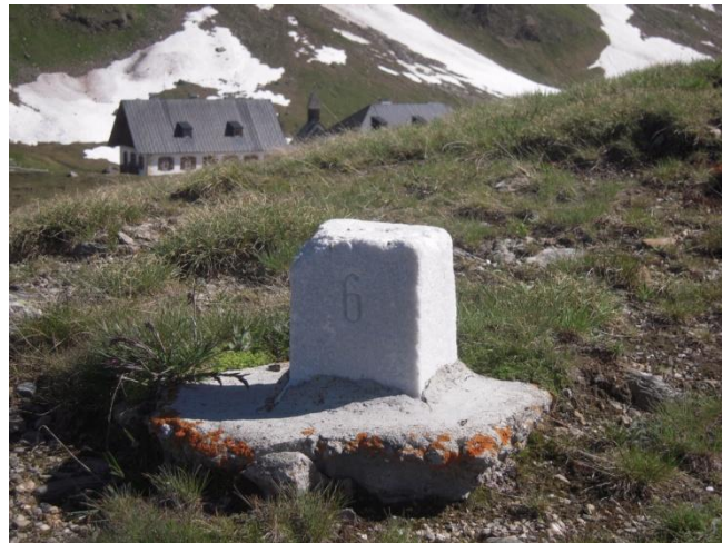
Abb.7.2: Beispielfoto des Marmorpunktes MP 6 . Mit derartigen Punkten wurde das trigonometrische Vermessungsnetz in der zweiten Blütephase des Abbaus vermarktet. Im Hintergrund ist die Schutzhütte am Schneeberg (damals Herren- und Gasthaus) zu sehen (Wandinger M, 2010).
